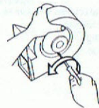
Figur 10. Fläkthjulet lossas från flätkåpan genom att demontera skruvarna på flätkåpan sida.
