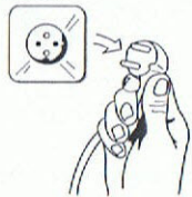
Figur 5. Före rengöring av värmeväxlare och fläktar etc skall aggregatet alltid göras spänningslöst.
