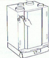
Figur 15. Öppning av aggregatluckan.
