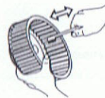
Figur 11. Fläkthjulets kåpa och fläktvingar rengöres med en borste.
